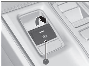
1 Elektromos rögzítőfék kapcsolója
