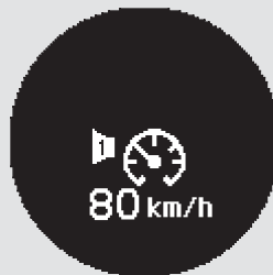
Riasztás a 80 km/h sebesség elérésénél beállítva.
